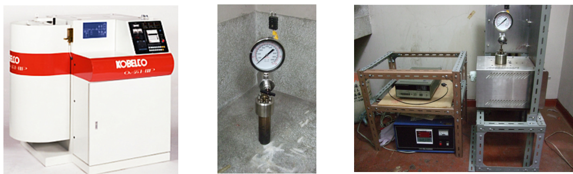
図 3.4: O 2 -Dr.HIP(左) [36] と Parr 社製高圧容器 (中央) 及びアニール装置 (右)
