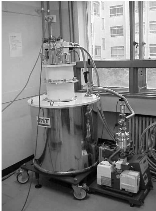
図 2.2: 液体 He-Free 超伝導マグネットの外観。写真下部が超伝導マグネット、その上部がクライオスタット。
