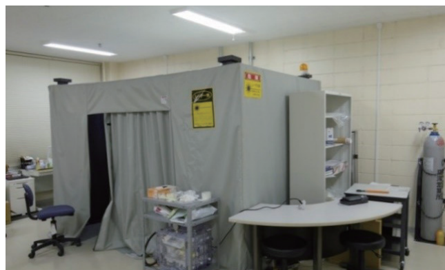
図2: PLD薄膜作製装置を覆う暗幕などの安全対策の外観。
